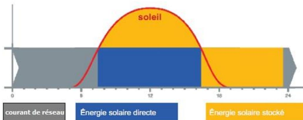
Dès le lever de soleil l'installation photovoltaïque commence à produire l'énergie électrique qui alimente tous les consommateurs ménagers et l'énergie excédentaire produite sera stockée dans les batteries. Et une fois le soleil se couche ou des nuages couvrent le soleil, les batteries assurent l'approvisionnement en énergie et seulement dans le cas où les batteries sont déchargées et il n'y plus de rayonnement solaire, l'électricité est tirée du réseau public.
